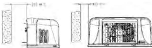
Le groupe de condensation caréné doit être installé dans un lieu bien aéré et non soumis aux vents dominants. Laisser libre la circulation d'air au niveau du condenseur. Aucun obstacle frontal ou latéral ne doit le perturber afin d'éviter tout phénomène de recyclage d'air au condenseur pour éviter, entre autres, une température de condensation anormalement élevée. Le groupe de condensation caréné doit être fixé de niveau suivant les règles de l'art.
